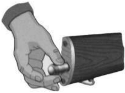
Рис. 7.12. Вынуть пенал с принадлежностью
