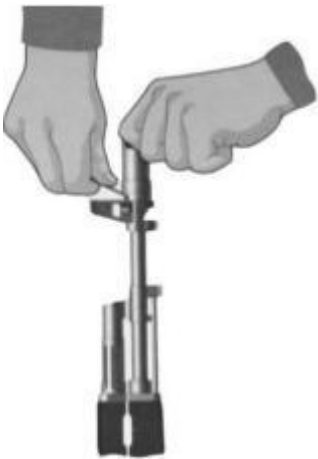
Рис. 7.12. Вынуть пенал с принадлежностью
