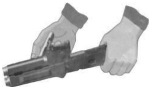
Рис. 7.17. Отделить затвор от затворной рамы
