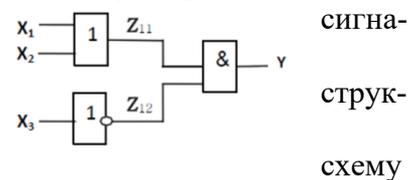
5. Получить таблицу соответствия/истинности по заданной турной схеме микропроцессорного устройства.
