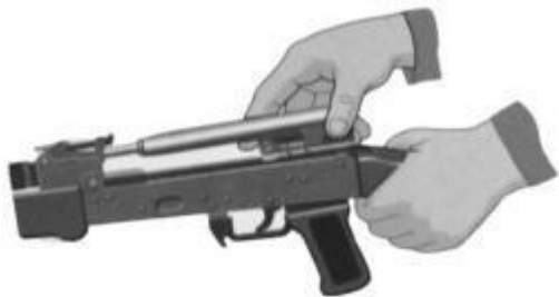
Рис. 7.16. Отделить затворную раму с затвором
