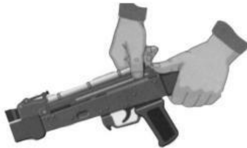
Рис. 7.14. Отделить крышку шомпол ствольной коробки
