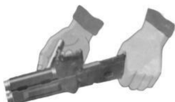
Рис. 7.18. Отделить газовую трубку со ствольной накладкой
