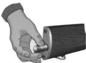
Рис. 7.12. Вынуть пенал с принадлежностью
