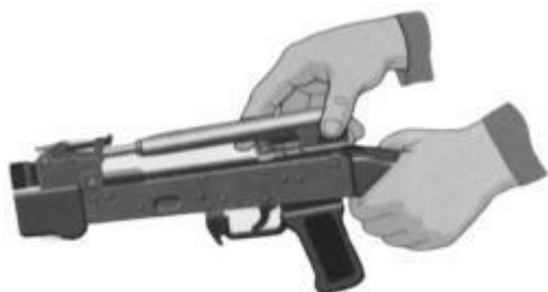
Рис. 7.16. Отделить затворную раму с затвором
