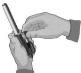
Рис. 7.17. Отделить затвор от затворной рамы
