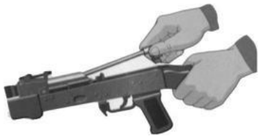
Рис. 7.15. Отделить возвратный механизм
