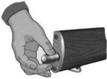
Рис. 7.12. Вынуть пенал с принадлежностью
