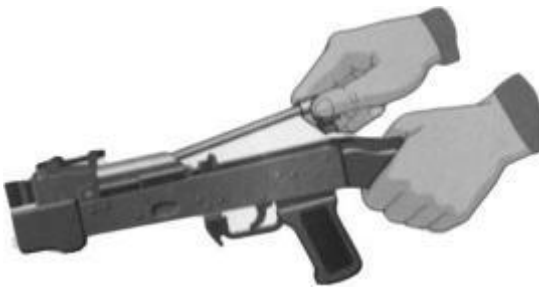
Рис. 7.13. Отделить Рис. 7.14. Отделить крышку шомпол ствольной коробки
