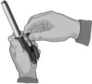
Рис. 7.16. Отделить затворную раму с затвором
