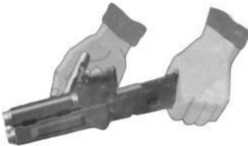
Рис. 7.17. Отделить затвор от затворной рамы
