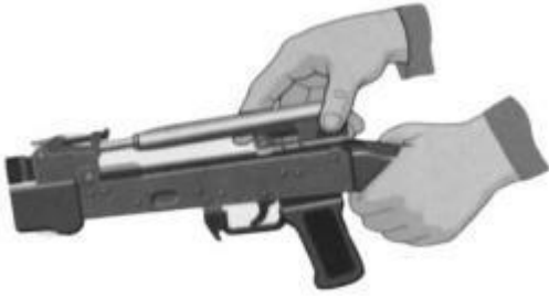
Рис. 7.16. Отделить затворную раму с затвором
