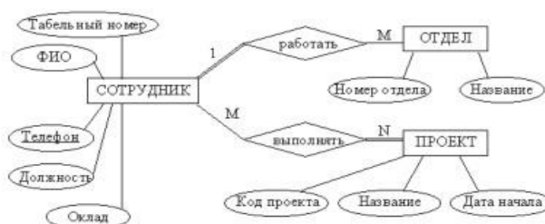
Рисунок 1. Пример ER–диаграммы с однозначными и многозначными атрибутами
