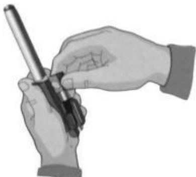
Рис. 7.17. Отделить затвор от затворной рамы
