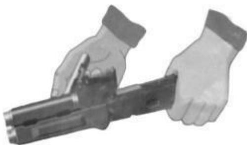
Рис. 7.18. Отделить газовую трубку со ствольной накладкой
