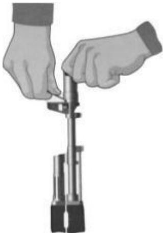
Рис. 7.13. Отделить Рис. 7.14. Отделить крышку шомпол ствольной коробки
