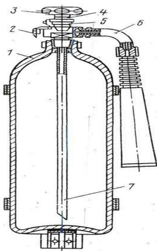
Рисунок 3- Углекислотный огнетушитель ОУ- 5
