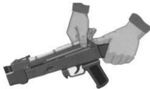
Рис. 7.13. Отделить Рис. 7.14. Отделить крышку шомпол ствольной коробки
