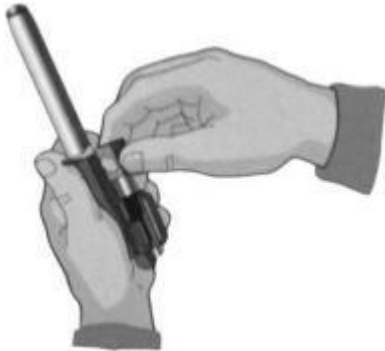
Рис. 7.16. Отделить затворную раму с затвором
