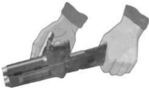
Рис. 7.17. Отделить затвор от затворной рамы
