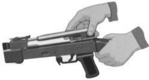
Рис. 7.16. Отделить затворную раму с затвором
