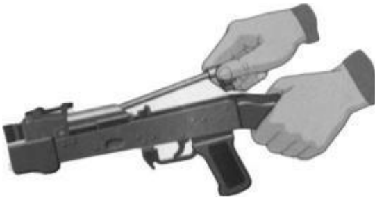
Рис. 7.13. Отделить Рис. 7.14. Отделить крышку шомпол ствольной коробки
