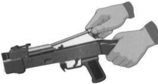
Рис. 7.13. Отделить Рис. 7.14. Отделить крышку шомпол ствольной коробки
