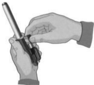
Рис. 7.16. Отделить затворную раму с затвором
