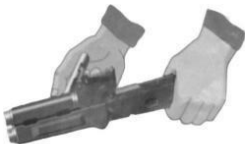
Рис. 7.17. Отделить затвор от затворной рамы
