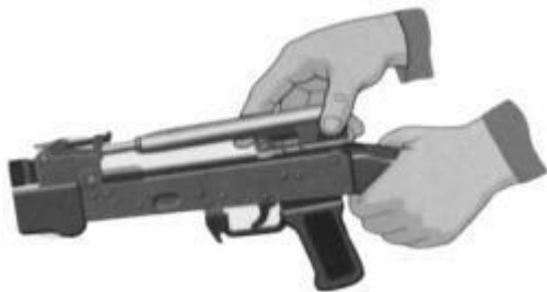
Рис. 7.16. Отделить затворную раму с затвором
