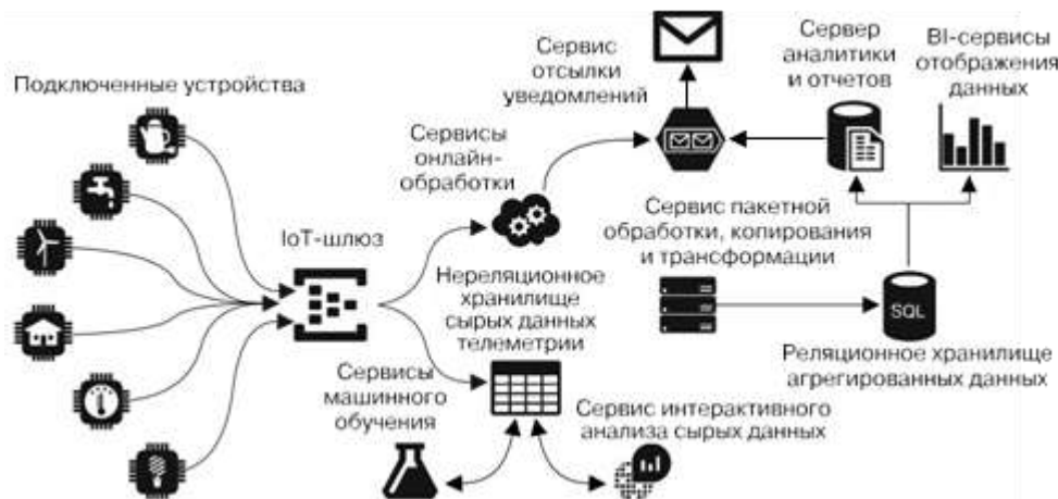
Рис. 2.1. Архитектура системы учета электроэнергии, построенная на основе разделения хранилищ сырых и агрегированных данных — так называемая лямбда-архитектура
