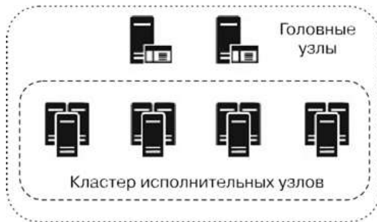
Рис. 3.5. Общая структура масштабируемой системы, построенной на основе кластера
