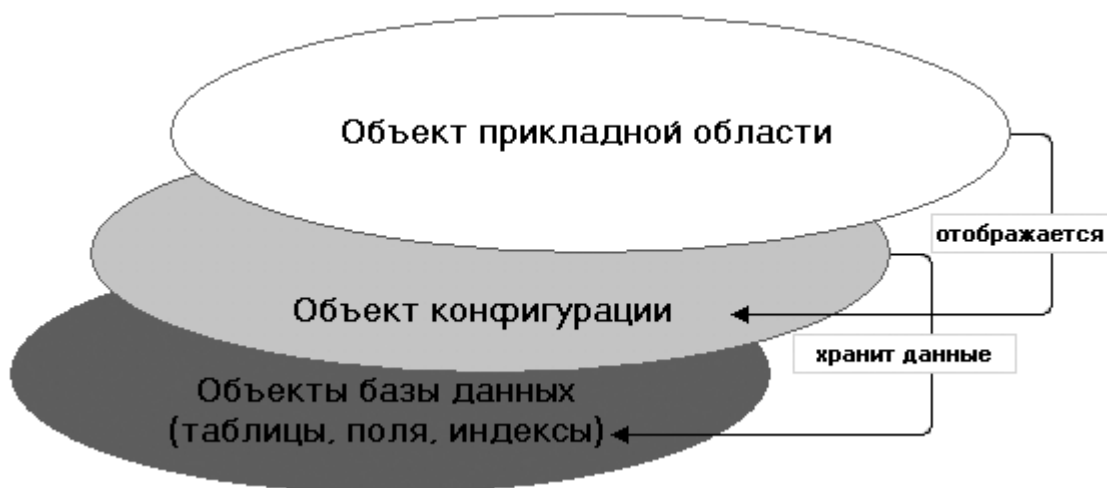
Рис. 3.2. Схема представления и манипулирования данными в системе «1С:Предприятие»
