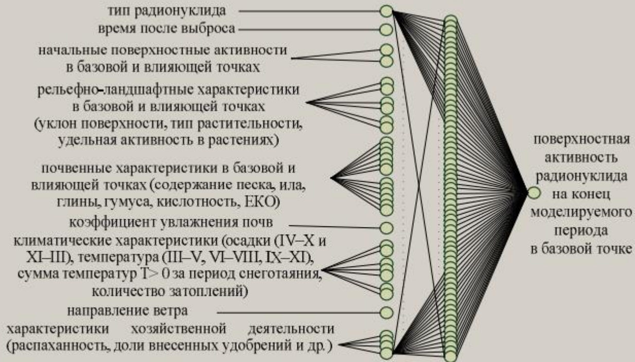
Рисунок 1 – Топология многослойного персептрона {34–69–1} для прогнозирования латеральной миграции радионуклидов в пределах элементарного ландшафта
