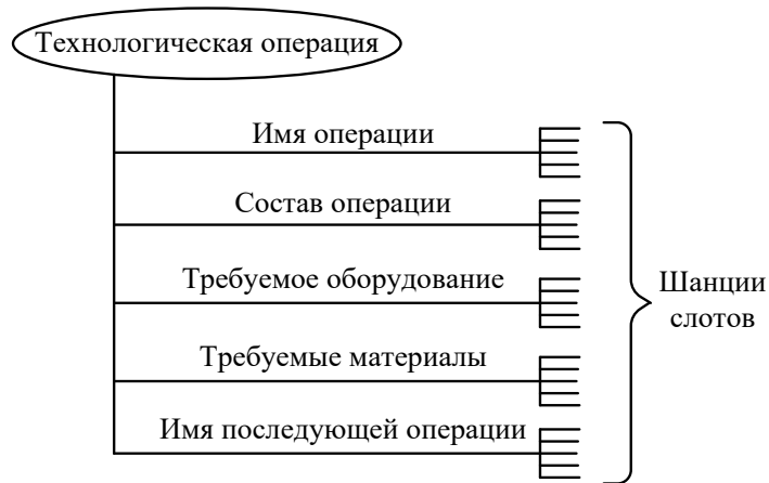
Рис. 3.3. Фрейм понятия "технологическая операция"
