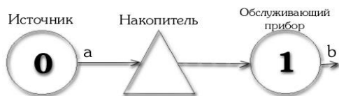
Рисунок 14 – Одноканальная система с ожиданием
