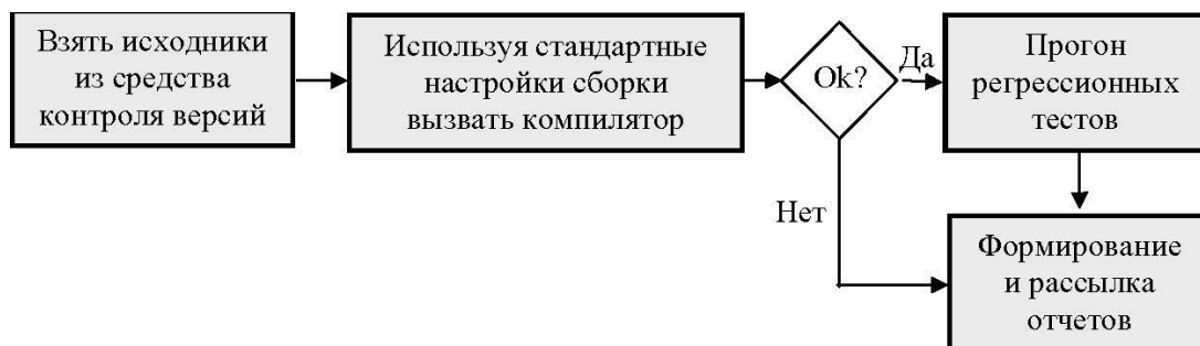
Рисунок 7.9 – Общая схема автоматизированной сборки
