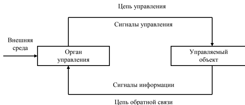
Рисунок 8 – Схема системы управления с цепью обратной связи
