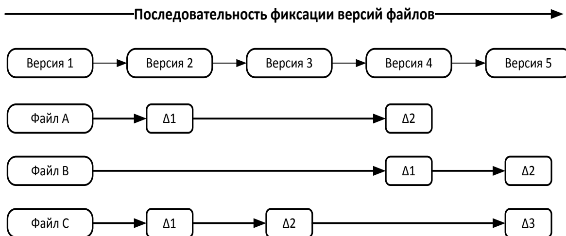
Рисунок 7.5 – Хранение данных как изменения к базовой версии для каждого файла
