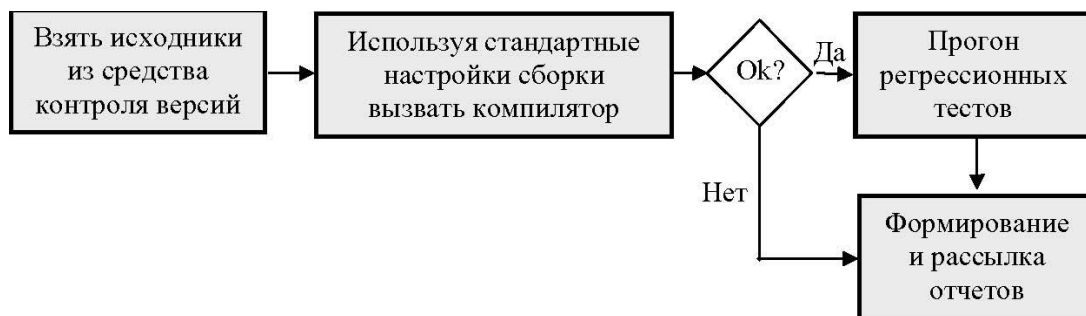
Рисунок 7.9 – Общая схема автоматизированной сборки
