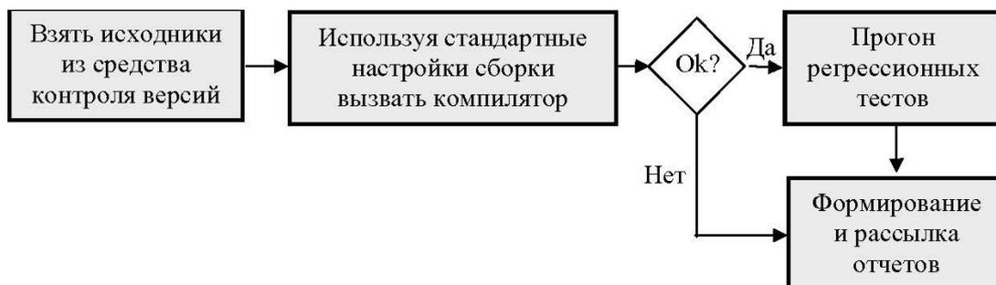
Рисунок 7.9 – Общая схема автоматизированной сборки
